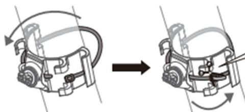
Schneiden Sie die Kabelbinderenden mit Hilfe einer Schere ab.
