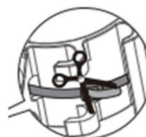
Bringen Sie das Rücklicht in eine horizontale Position, setzen Sie es auf den Halter, drehen es um 90° und befestigen Sie es am Halter.
